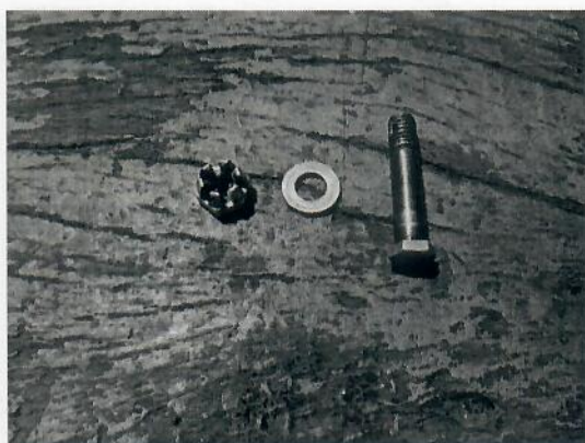
Axe (boulon) et ses composants
